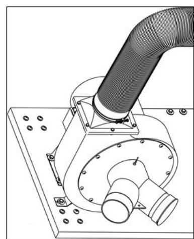
10. De stofafzuiging is nu klaar voor gebruik. De stofafzuiging kan nu worden aangesloten op de machine waarvoor deze bedoeld is, let er hierbij op dat de verbindingsslang stevig wordt bevestigd op zowel de inlaat van de stofafzuiging als op de aansluiting van de machine.
