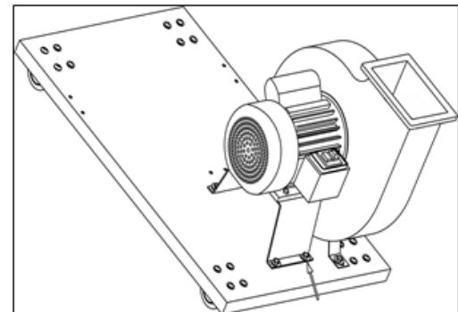
3. Monteer vervolgens de slangaansluiting (L) op de afzuiging, plaats eerst de pakking (I) en vervolgens de slangaansluiting. Zet deze vast met de bijgeleverde bouten, ringen en moeren.
