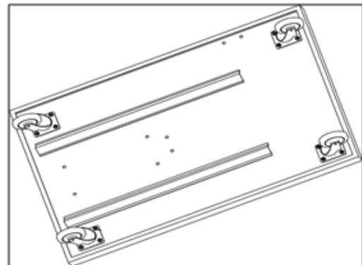
2. Bevestig vervolgens de ventilator/afzuiging op het onderstel met de bijgeleverde bouten, ringen en moeren.
