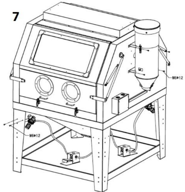
8. Platzier Sie jetzt die Staubabsaugung gegen die Kabine, richten Sie die Löcher aus und setzen Sie den Staubabsaugung fest mit die M6x12mm Bolzen und M6 Muttern, brauchen Sie Kit um die Öffnung zwischen der Extraktion und den Schrank zu dichten, sonst kommt da noch immer Staub frei während des Gebrauchs.
