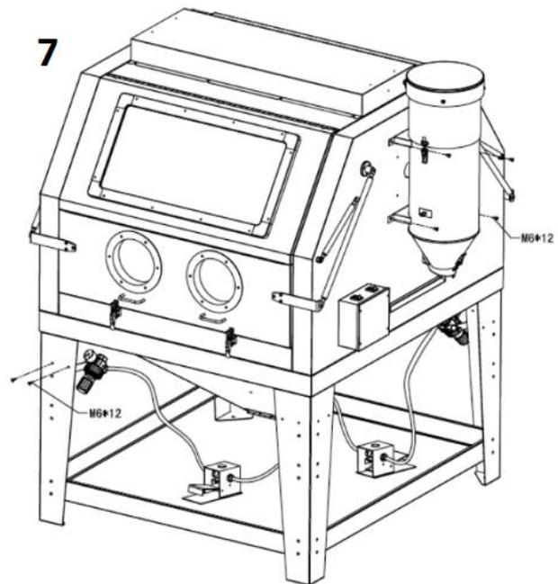
8. Plaats nu de stofafzuiging tegen de cabine, lijn de gaten uit en zet de afzuiging vervolgens vast met de M6x12mm boutjes en M6 moeren, gebruik kit om de opening tussen de afzuiging en de kast te dicht, anders komt er alsnog stof vrij tijdens gebruik.
